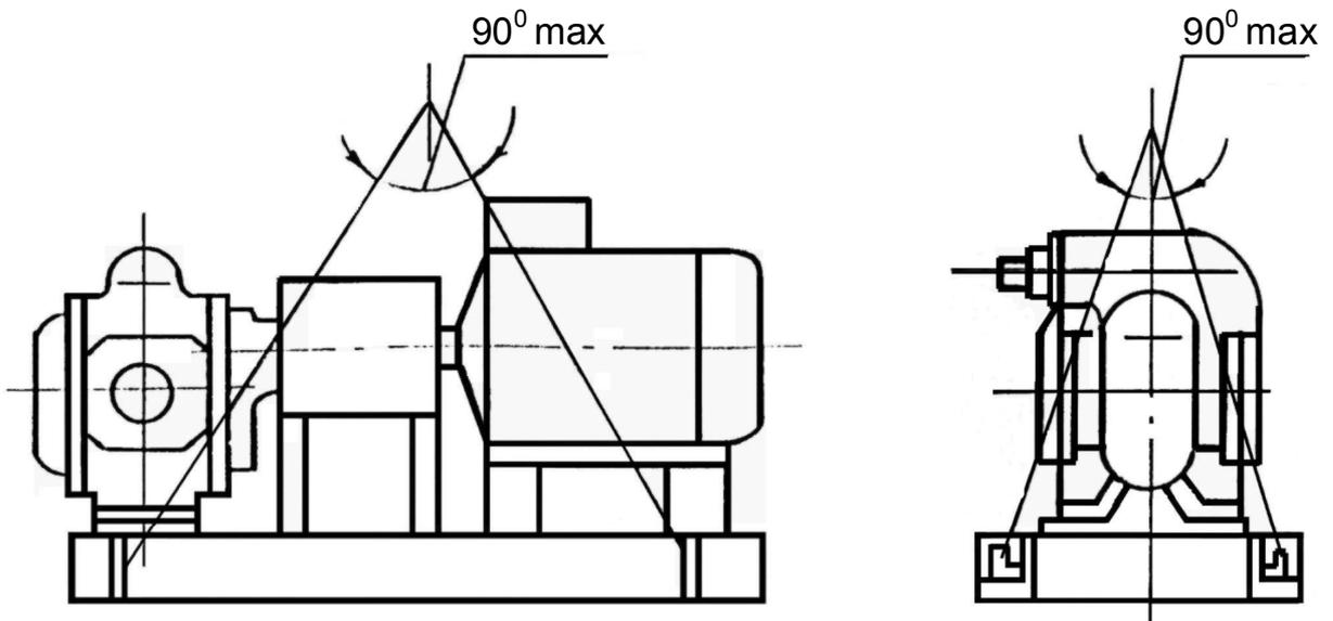
Схема строповки агрегатов на плите
